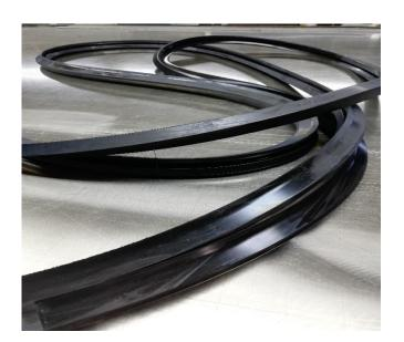
**IDS- PROFILDICHTRINGE** sind als "Lippendichtringe" ausgebildet und formgebundene Endlosdichtringe die frei von Nahtstellen sind. Das auf der gesamten Dichtlänge gleichbleibende Profil, sowie die Verwendung einer speziell abgestimmten Elastomermischung, sorgen für lange Standzeiten und hervorragende Dicht - und Nitrierergebnisse. Der jeweilige **KGO-Nitrierofen** erfährt durch den Einsatz dieses Profildichtrings eine höhere Betriebssicherheit.
